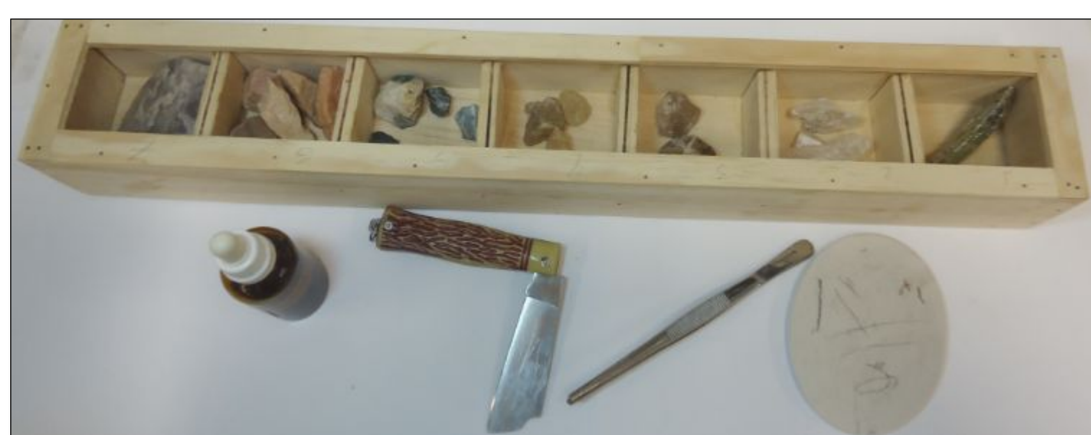
Figura 5: Materiais necessários para se determinar as propriedades físicas dos minerais: Escala de Mohs, canivete, pinça para manuseio, placa de porcelana e ácido clorídrico diluído.
