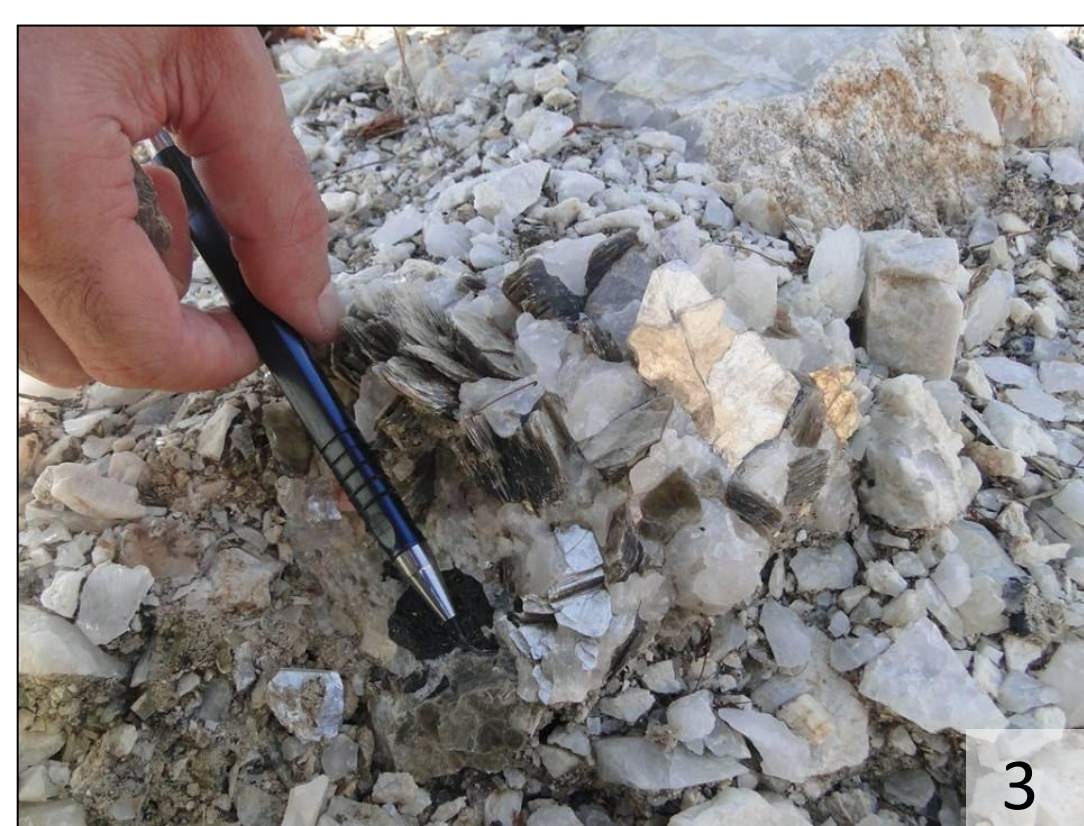
Figuras 3 e 4: Exemplos de amostras coletadas em aulas práticas de campo. Figura 3: Pegmatito contendo feldspato (albita), quartzo e mica. Figura 4: Ocorrência de opala em rocha arenítica.
